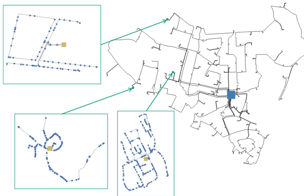
Abbildung 37: Versorgungsknoten-9-Netz mit beispielhaft zugeordneten Niederspannungsnetzen
