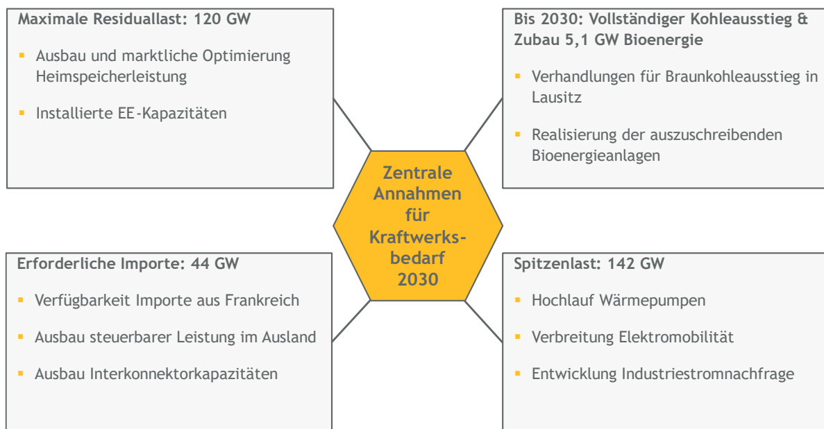
Abbildung 1: Annahmen für den notwendigen Zubaubedarf von steuerbarer Leistung und Einflussfaktoren (Auswahl)
